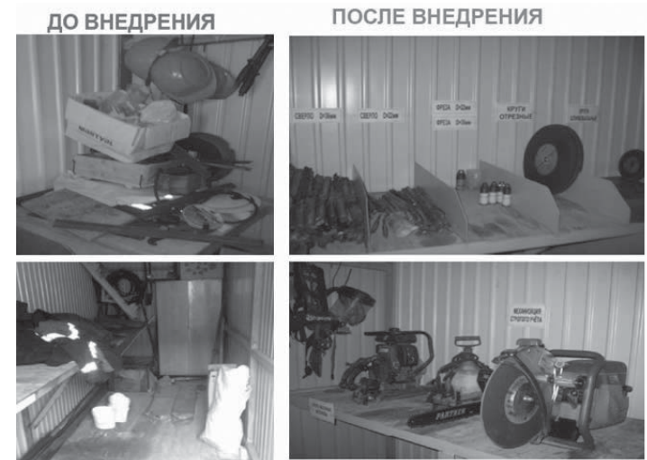
Рис. 3. Оборудование кладовой для хранения инструмента согласно требованиям 5S ст. Зеленогорск, 4 околоток
