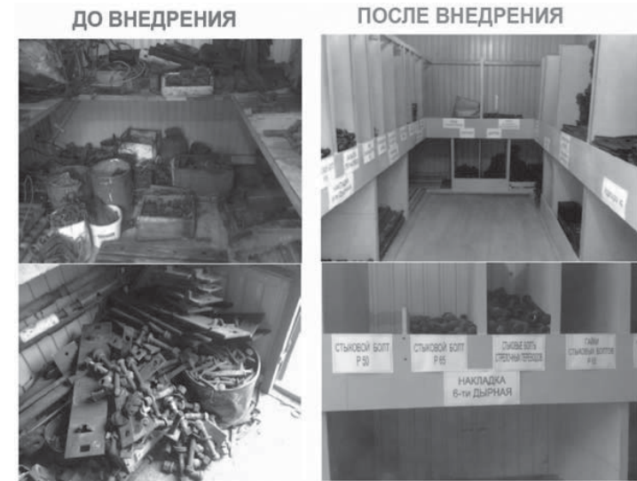
Рис. 2. Оборудование кладовой для хранения материалов верхнего строения пути согласно требованиям 5S
